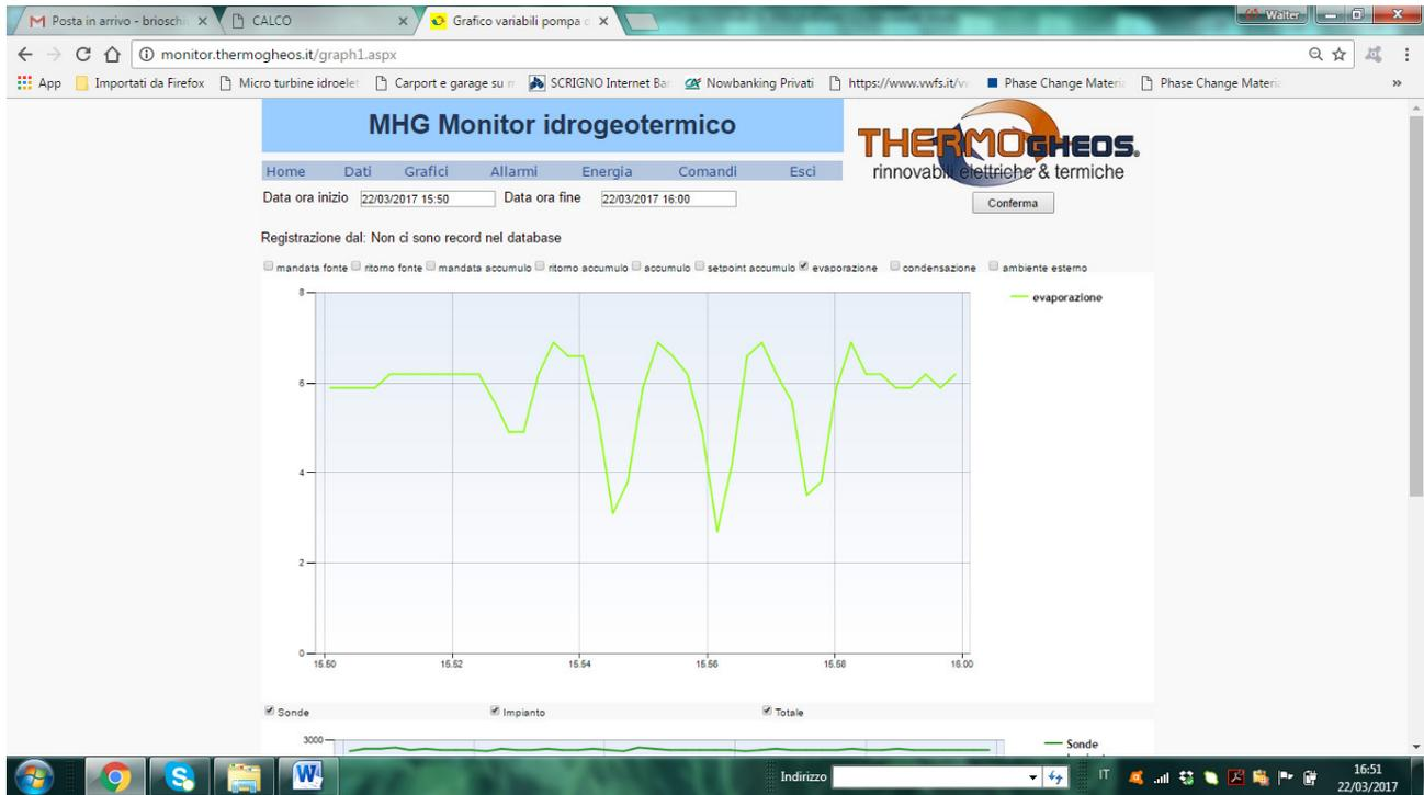
NOTA : la pressione di evaporazione varia durante il pendolamento da un minimo di 3°C a un massimo 7°C; ciò significa che la pressione di evaporazione varia da 7,82 a 8,97 barg. Lo stesso succede per la temperatura/pressione di condensazione.
